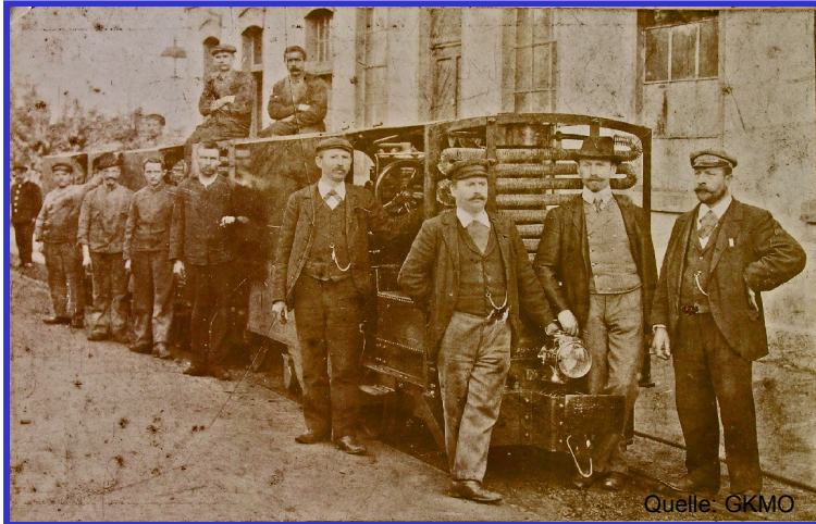
Oberurseler Feldbahn-Motor-Lokomotive mit Treibstangen-Antrieb
