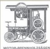
MOTOR-BRENNHOLZSÄGE MIT UND OHNE BELBSTFAHRVORRICHTUNG
